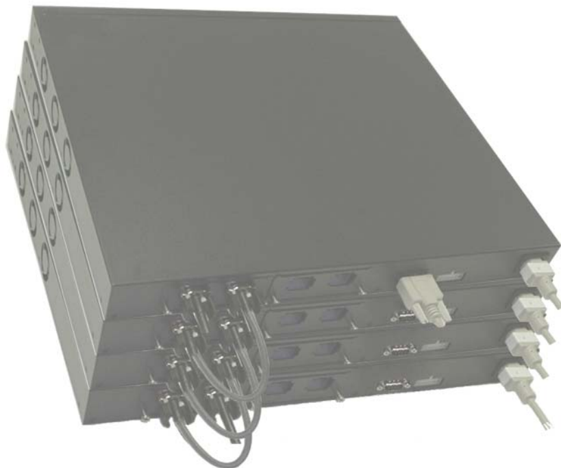
图 1-3. 连接堆叠交换机
