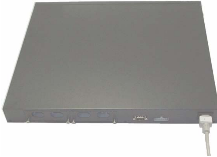
Figure 1-2. Branchement du câble d'alimentation
